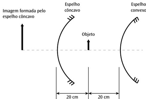
Aplicando a equação de Gauss para a formação da imagem pelo espelho côncavo, temos:
