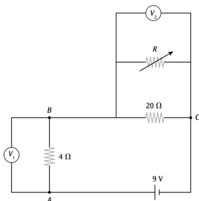
Para que  $V_1$  e  $V_2$  indiquem a mesma diferença de potencial, a resistência equivalente entre os pontos  $A$  e  $B$  e entre os pontos  $B$  e  $C$  do circuito devem ser iguais, portanto:
