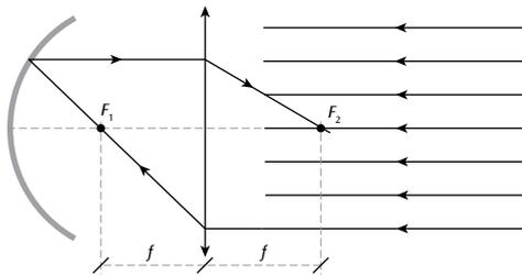
Assim, os pontos  $F_1$  e  $F_2$  correspondem aos focos principais da lente, se  $\overline{F_1F_2} = 40 \text{ cm} \Rightarrow f = 20 \text{ cm}$ .
